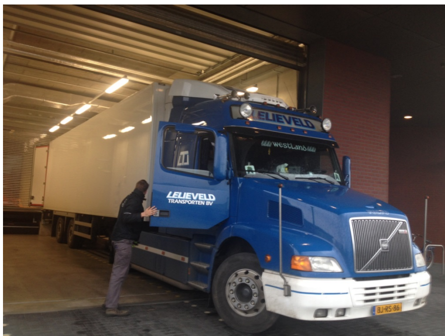
Controle vooraf van de maten van de vriestruiker, het wagengedeelte wordt na transport afgekoppeld; let ook op voldoende hoogte
